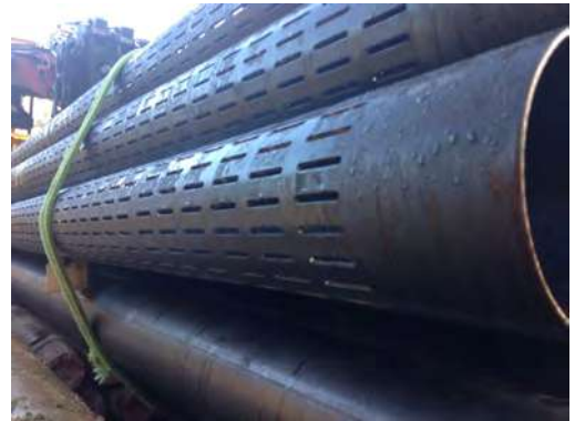
Tubes acier crépinés diam 139,7 mm
