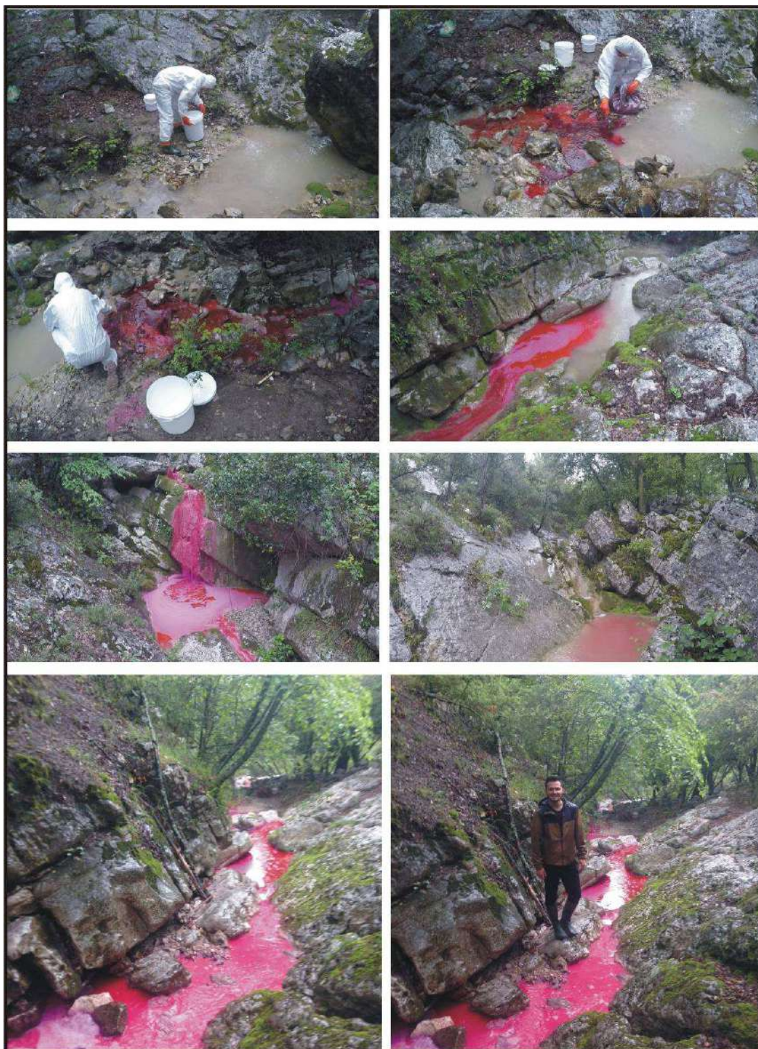
Injection de 15 kg de sulforhodamine B, perte de la Sauréa le 22/05/2018
