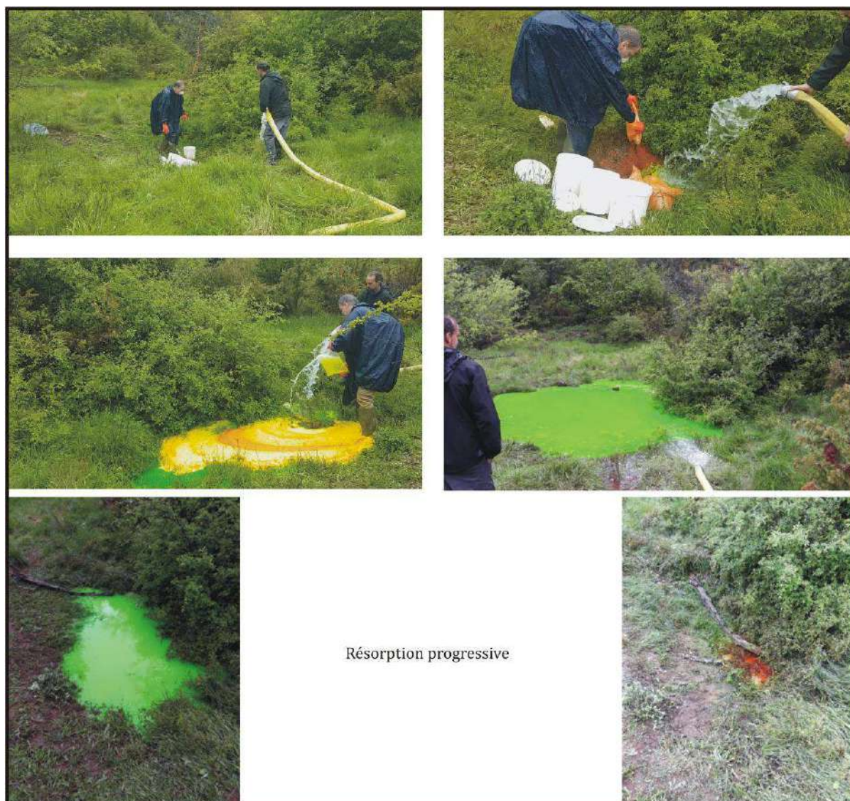
Injection de 20 kg de fluoresceïne dans la doline 864 m NGF de la barre de Lendre le 22/05/2018
